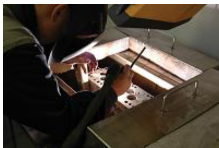
Spawanie aluminium metodą TIG w osłonie argony w piecu spawalniczym
